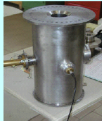
352 MHz, \beta=0.31 HWR - LNL
